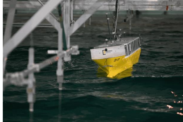
© Bertrand MALAS / Essais en bassin de tenue à la mer en houle directionnelle
