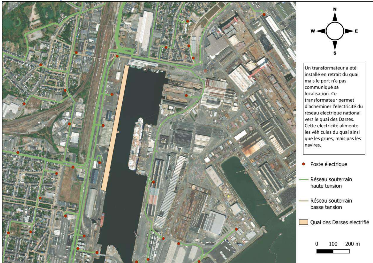
Figure 8 : Électrification du quai des Darses et des Charbonniers
