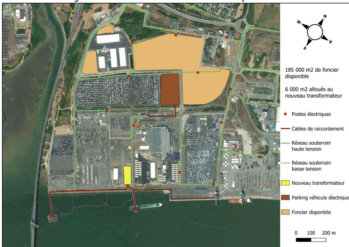
Figure 10 : Potentialité d'électrification du quai roulier
